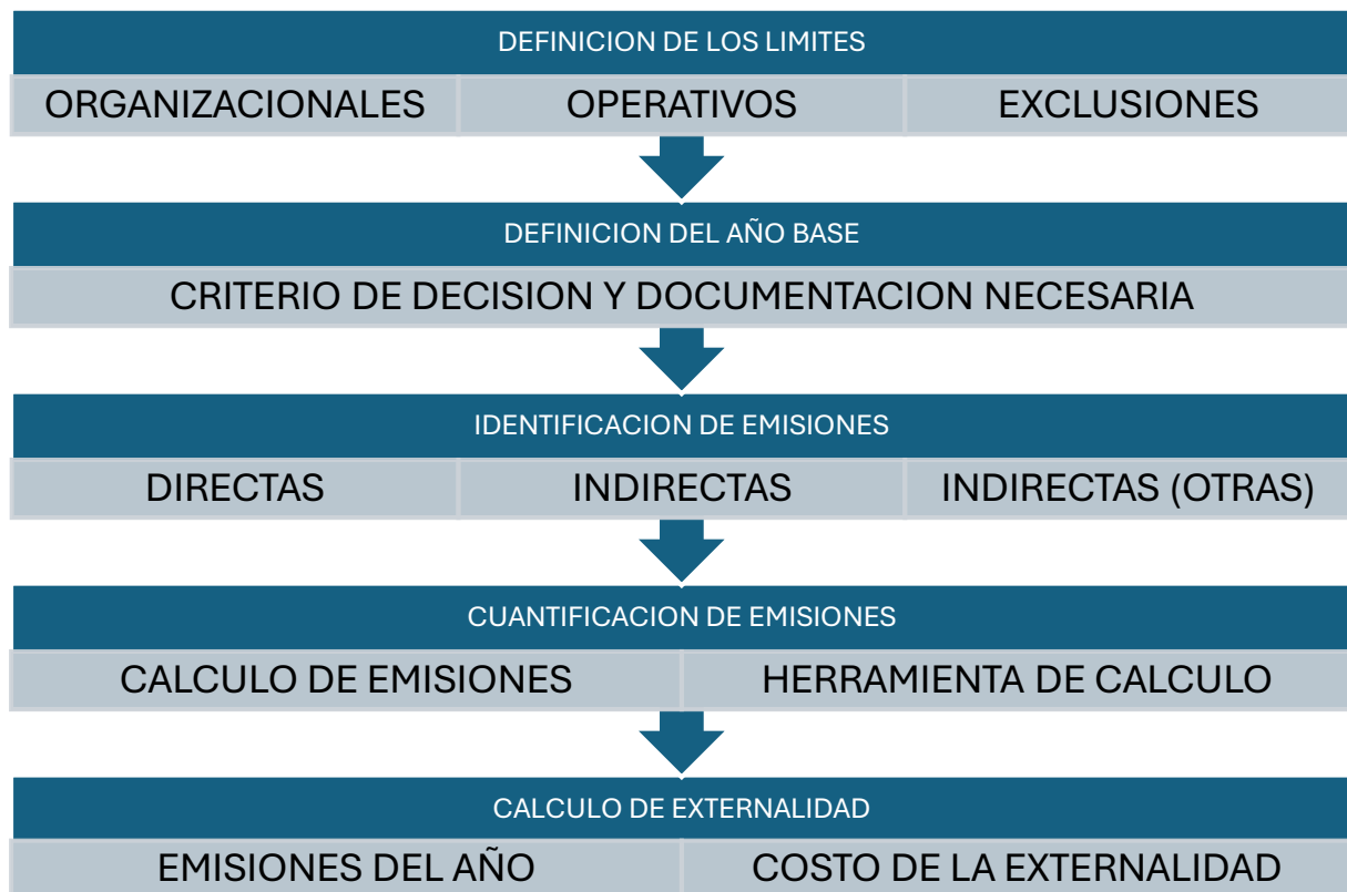
Figura1. Flujograma para realizar el cálculo de las externalidades por GEI. Se trabajó solo con las emisiones directas.
