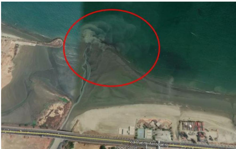
Figura 4. Obsérvese la desembocadura del río Muerto en la playa. La presencia de sedimentos en suspensión y desechos contaminantes se puede apreciar con claridad en esta imagen (círculo rojo). Fuente: Imagen cortesía de Google Earth 2020.
